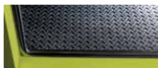
Металлический пол контейнера с рифленой поверхностью
