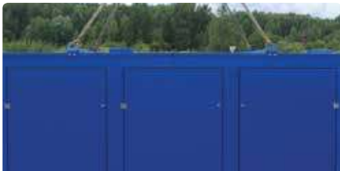
Отверстия для строповки
