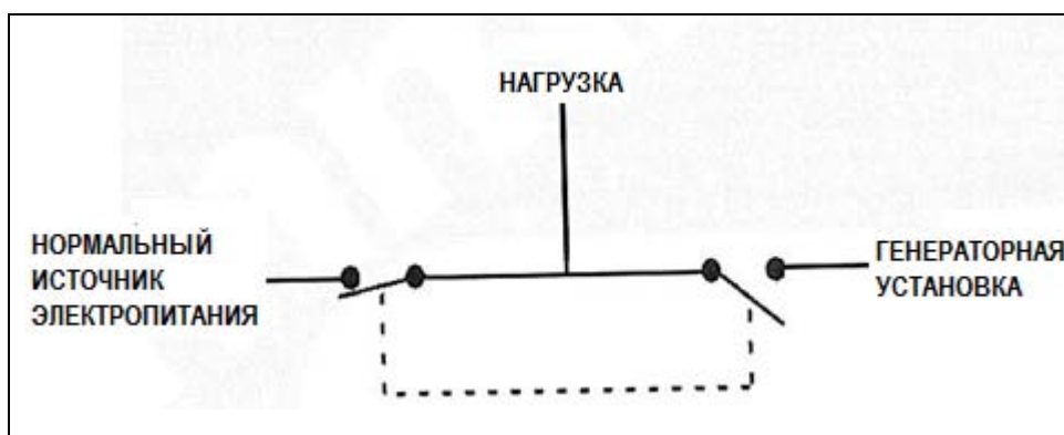
Рис. 12 Функция типового устройства переключения нагрузки
