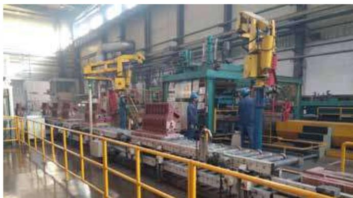
Конвейер по производству блоков цилиндров
